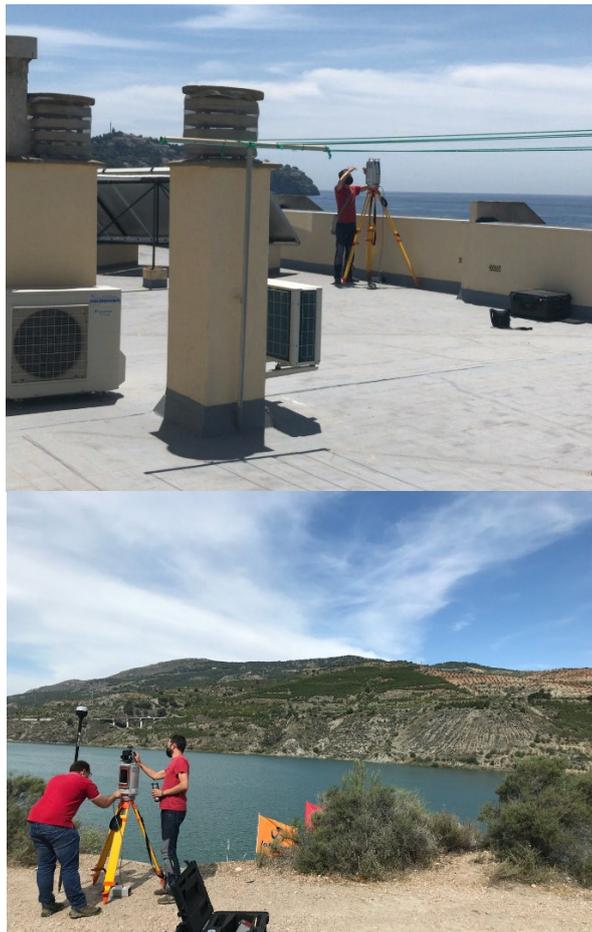
Figura 2: El sistema TLS utilizado durante las campañas de Cerro Gordo (arriba) y Rules (abajo)
